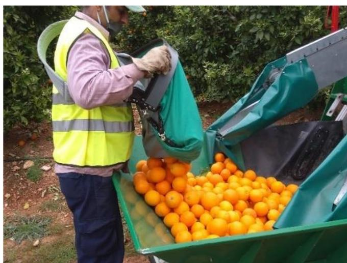
**Figura 29.** Operario descargando la bolsa recolectora en la tolva del prototipo.
