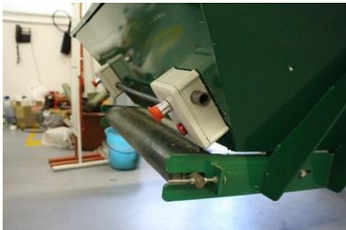
**Figura 14.** Botones pulsadores de seguridad instalados en la parte delantera de la tolva del prototipo.
