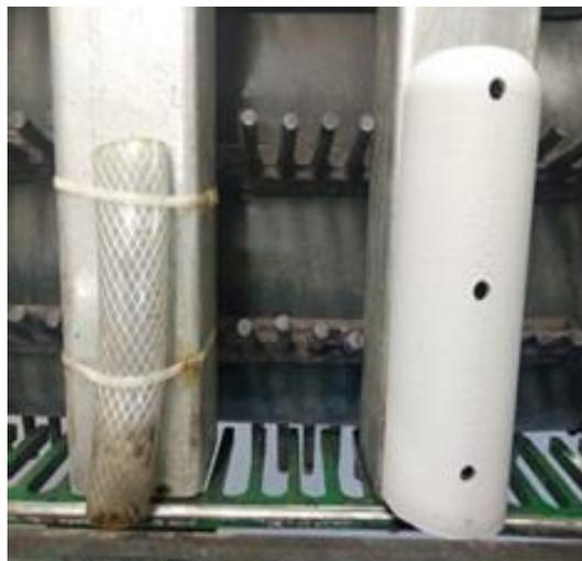
**Figura 19.** Dispositivos para reducir el ascenso de fruta al sistema de visión. **Izq.)** Diseño metálico anterior con superficie plana. **Dcha.)** Diseño plástico actual con superficie redondeada.
