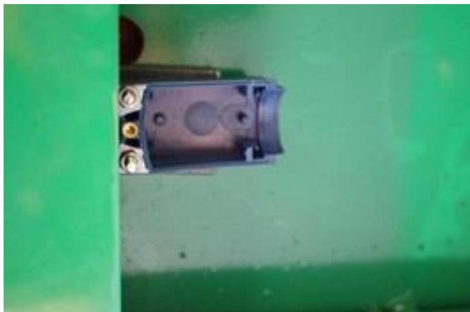
**Figura 13.** Limitador de carrera colocado en una de las tarimas extensibles del prototipo.
