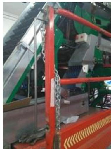
**Figura 11.** Modificaciones llevadas a cabo en la sección de las escaleras de acceso a las tarimas del prototipo. **a)** Desnivel presente en la zona de paso de las escaleras. **b)** Asideros para facilitar la subida a las plataformas.
