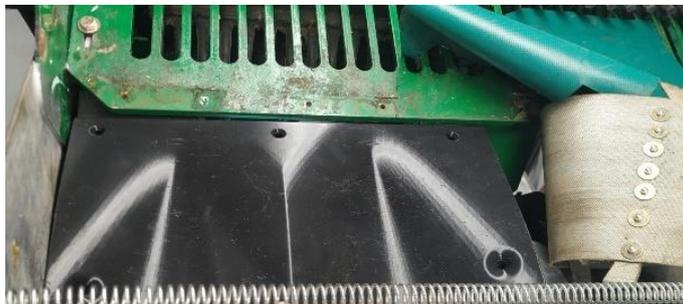
**Figura 20.** Dispositivo de asistencia en la colocación de la fruta entre los rodillos.
