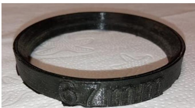
**Figura 31.** Anillo de material plástico PLA para clasificar la fruta en función de su diámetro.
