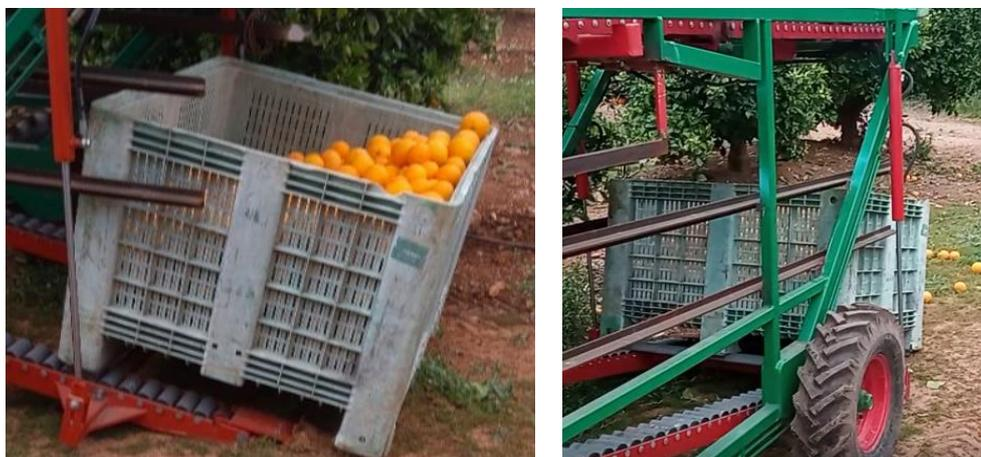
**Figura 35.** Izq.) Vista lateral del contenedor antes de desbordarse la fruta. Dcha.) Vista trasera del contenedor tras caerse la fruta al suelo.
