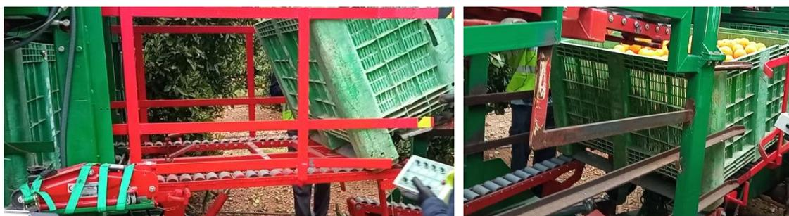
**Figura 34.** Izq.) Carga de contenedor del remolque al prototipo. Dcha.) Descarga de contenedor del prototipo al remolque.
