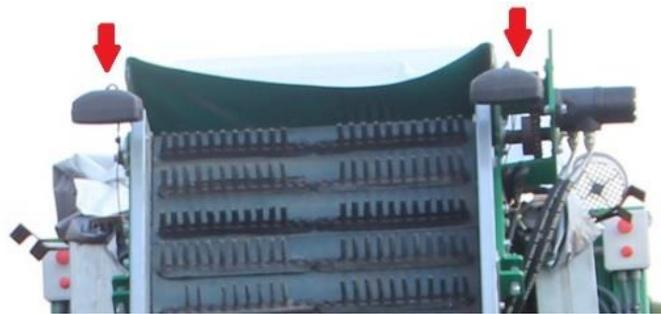
**Figura 8.** Focos de trabajo instalados en el prototipo en posición de no encendido.
