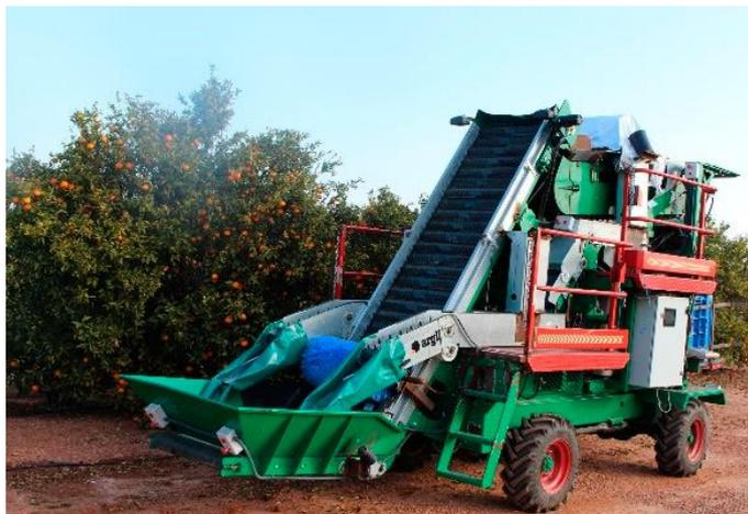
**Figura 1.** Prototipo de plataforma de asistencia a la recolección.
