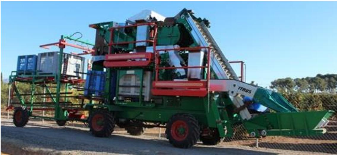
**Figura 4.** Prototipo de plataforma móvil con remolque auxiliar.
