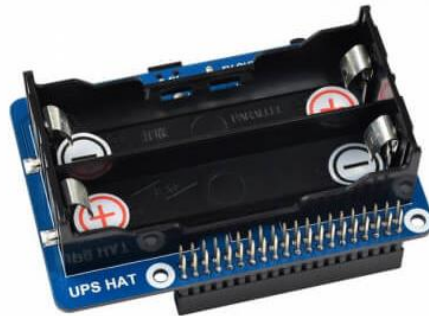
Figura 14. Sistema de alimentación ininterrumpida UPS HAT
