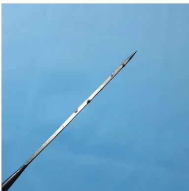
Fig 17.De esquerra a dreta. Agulla espinada de felting. Aspecte inicial del procés i aspecte del acabat.
