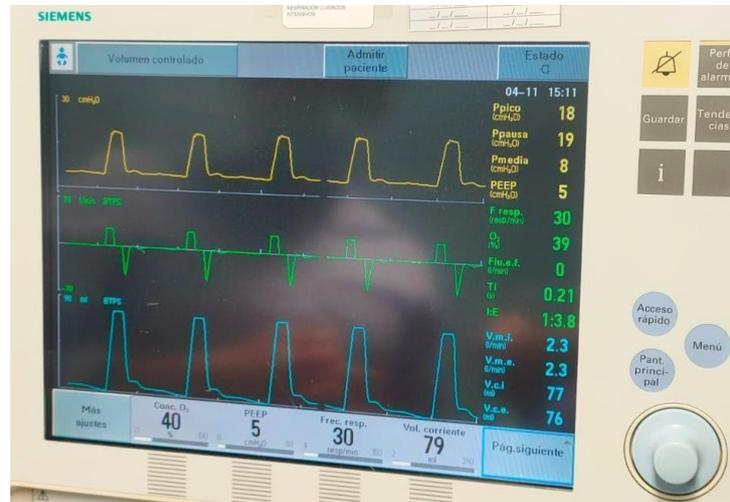
**Figura 16. Curvas de presión/volumen de modalidad ventilatoria VCV.**
