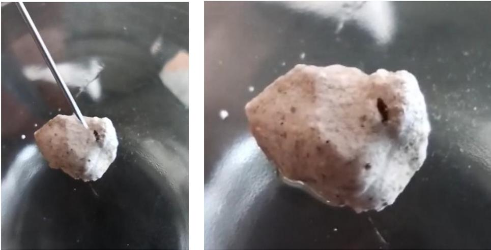
**Figuras 158-159.** Imagen de la muestra extraída del muro para la prueba de efervescencia. Donde se ha depositado una gota de ácido clorhídrico en varias muestras de mortero. Se produjo cierto burbujeo, sin embargo, ha sido muy baja la efervescencia, indicando que incluye un poco de cal, pero no es un material constituyente de este.
