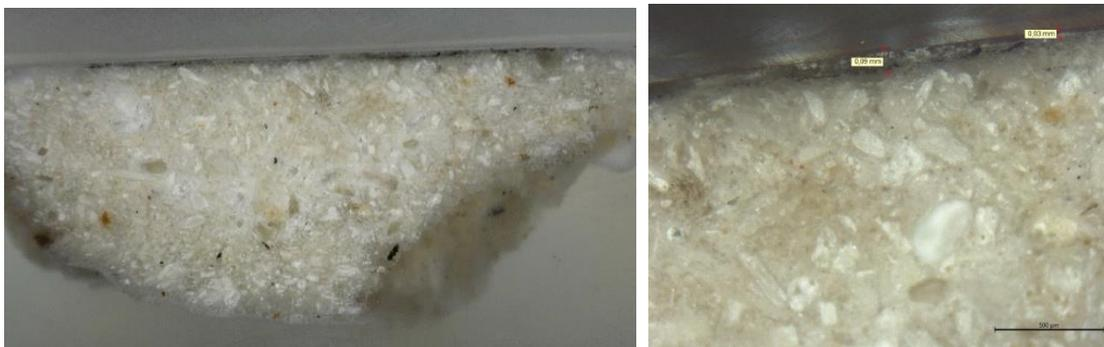
**Figura 163.** Estratigrafía en la que se aprecia el mortero preparatorio y el fino estrato pictórico
