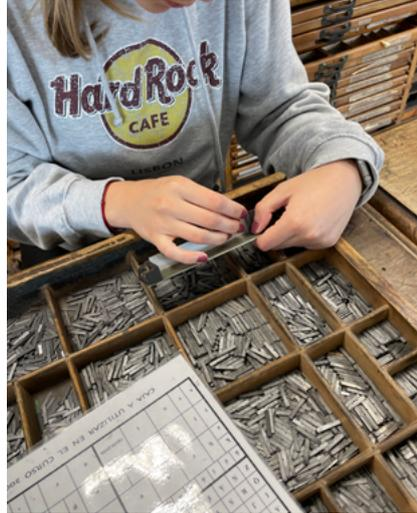
Fig.48. Celia Gómez. Colocación de los tipos móviles sobre la guía
