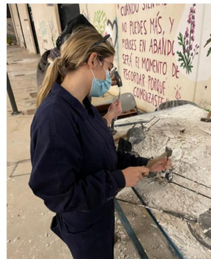
**Fig.26.** Celia Gómez. Extracción de la pieza del molde
