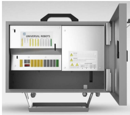
Figura 3.2: Interior de la Caja de control UR3
