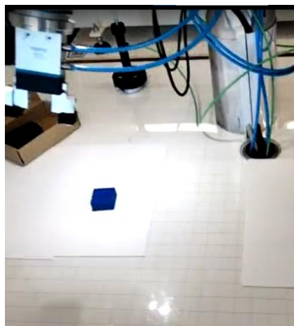
Figura 10.2: Robot UR3 en la posición Snapcam_1 buscando la pieza cuadrada.
