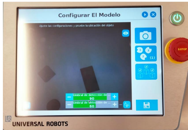
Figura 9.11: Pantalla del ajuste del umbral de detección, del test de detección y de la toma de posición de referencia.
