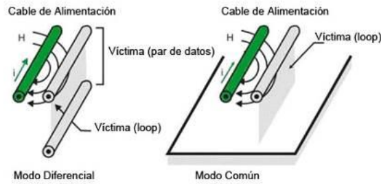
Ilustración 7: Acoplamiento inductivo por campo magnético. Fuente: Artículo técnico “Acoplamiento inductivo y cómo minimizar sus efectos en la industria (Smar Technology)”.
