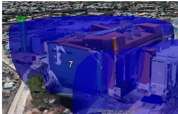
Ilustración 24: Ubicación inicial del pararrayos 7 sobre el edificio 3.
