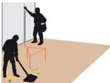
Ilustración 9: Tensiones de paso y de contacto. Fuente: at3w-learning Curso Protección Frente al Rayo.
