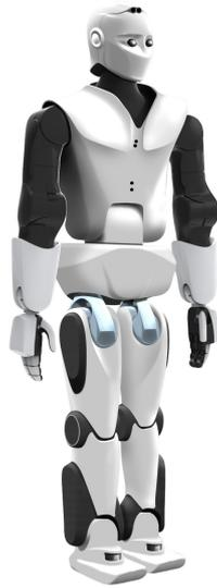
Figura 2.7: Robot para investigación Reem-c.
