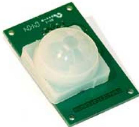
Figura 3.9: Sensor pyroeléctrico de presencia humana.
