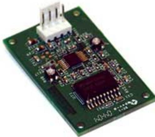
Figura 3.5: Sensor de inclinación 2 ejes.
