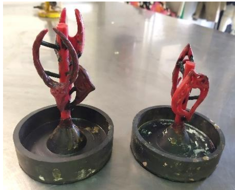
Fig. 55. Hau , Marina Botella, 2021. Montaje de los modelos en cera en árboles de colada.
