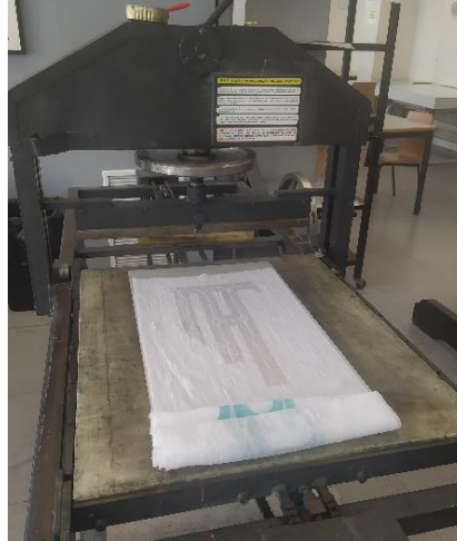
Fig. 110. Huchi , Marina Botella, 2021. Proceso de estampado sobre tela en prensa litográfica.
