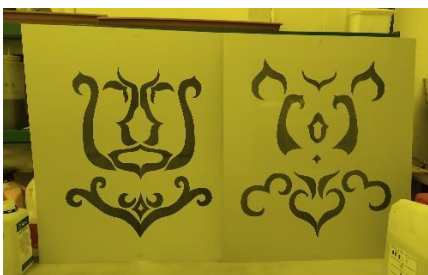
Fig. 108. Huchi , Marina Botella, 2021. Secado de las planchas tras el insolado.
