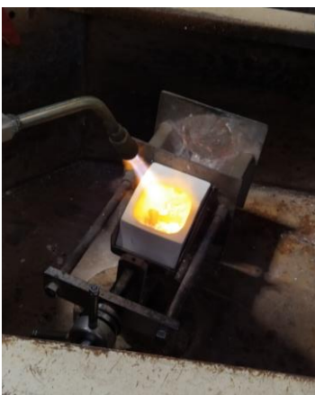
Fig. 57. Hau , Marina Botella, 2021. Proceso de microfundición: fundido del metal en el crisol.
