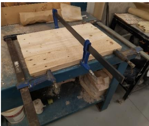
Fig. 122. Horari: Ape (fuego), madera de pino, Marina Botella, 2021. Encolado de los tabloncillos del palet.
