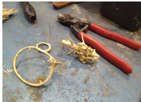
Fig. 61. Hau , microfusión, Marina Botella, 2022. Separado de las piezas del árbol de colada con tenazas.
