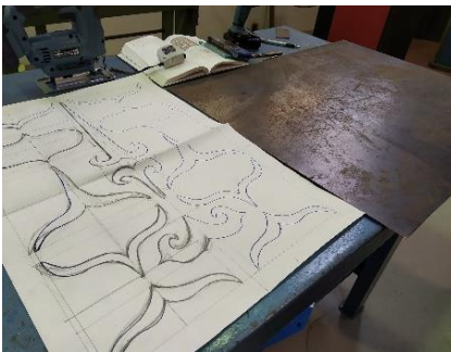
Fig. 125. Horari: Wakka (agua), plancha de hierro, Marina Botella, 2021. Transferencia de la plantilla.
