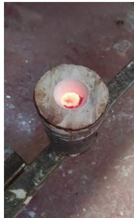
Fig. 58. Hau , Marina Botella, 2021. Proceso de microfundición: Metal vertido en el cilindro.
