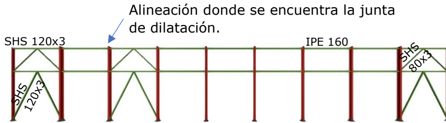
Ilustración 29M. Fachada lateral nave 2.
