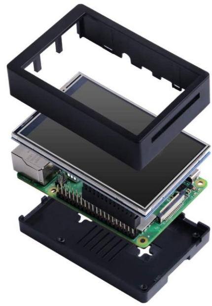
Figura 5- Elementos de montaje
