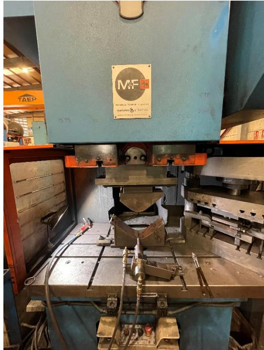
**Figura 15. Puesto de trabajo de la prensa dobladora.**
