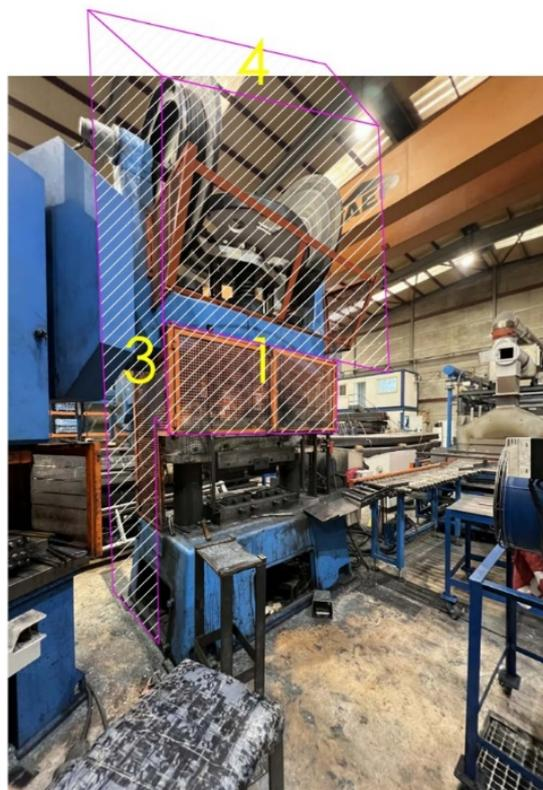
Figura 28. Esquema ubicación del encapsulamiento de la máquina de prensa de la zona de forja.
