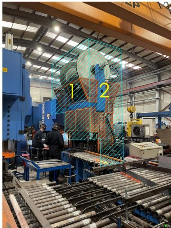
Figura 26. Esquema ubicación del encapsulamiento de la máquina de prensa de la zona de forja.
