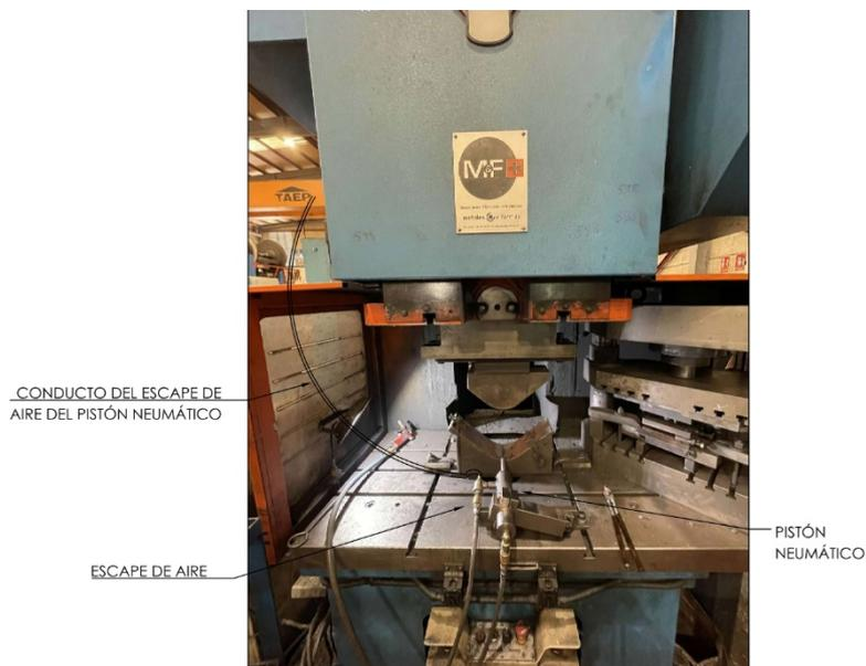
Figura 30. Propuesta de reconducción del escape del aire comprimido del pistón neumático.
