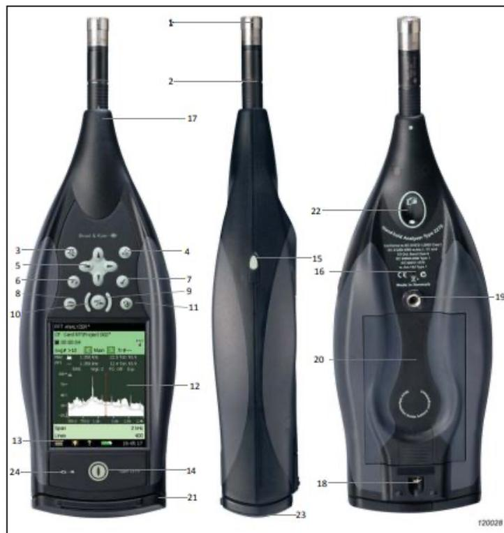
Figura 3. Diferentes vistas del sonómetro 2250 de Brüel & Kjær
