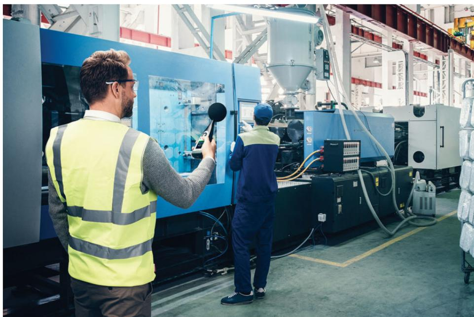
Figura 5. Imagen de una medición de la exposición al ruido en un puesto de trabajo. [8]
