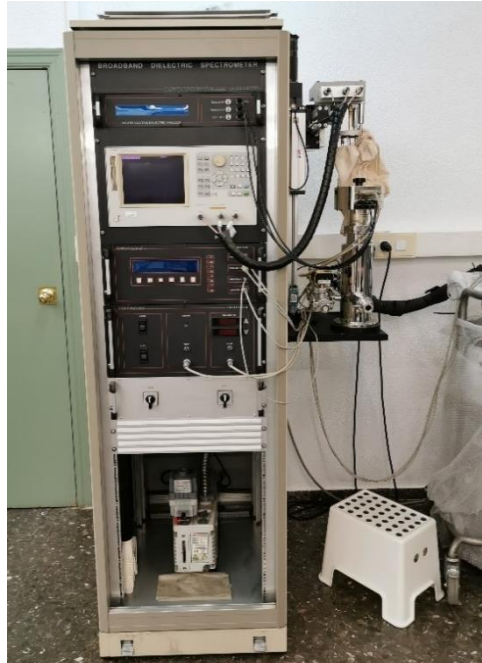
Figura 3.10: Imagen del espectrómetro dieléctrico conectado al Dewar de N 2 líquido (Figura de elaboración propia).
