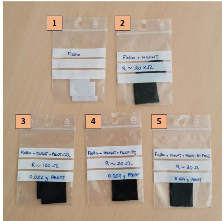
Figura 3.1: Imagen de las diferentes muestras objeto de estudio: (1) Feltro, (2) Feltro MWCNT, (3) Feltro+MWCNT+PEDOT:ClO 4 , (4) Feltro+MWCNT+PEDOT:PF 6 , (5) Feltro+MWCNT+PEDOT:BTFSI (Figura de elaboración propia).
