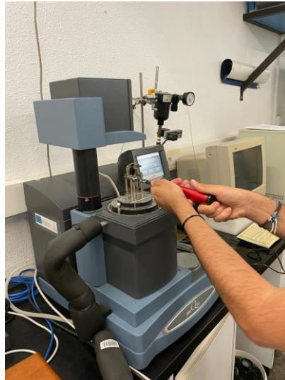
Figura 3.8: Proceso de atornillado de la muestra al equipo utilizando el destornillador dinamométrico de torque ajustable (Figura de elaboración propia).
