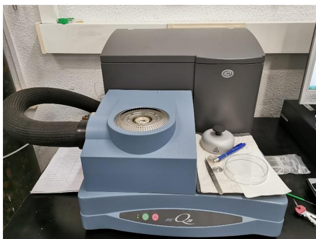
Figura 3.4: Imagen del equipo DSC Q-20 de TA Instruments (Figura de elaboración propia).
