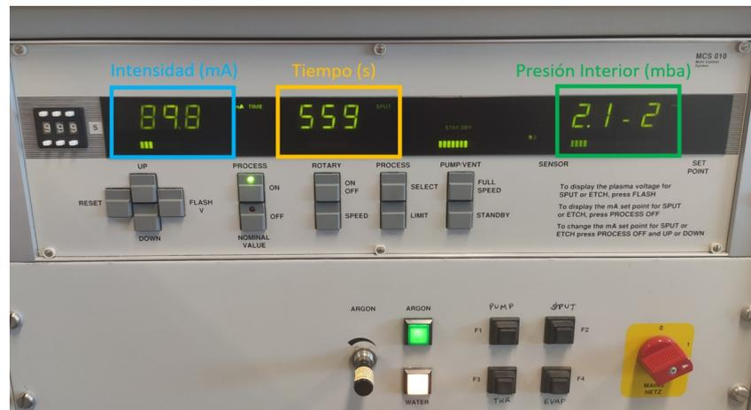
**Figura 3.4: Monitor con los datos que muestra el sistema mientras se lleva a cabo el proceso de sputtering.**
