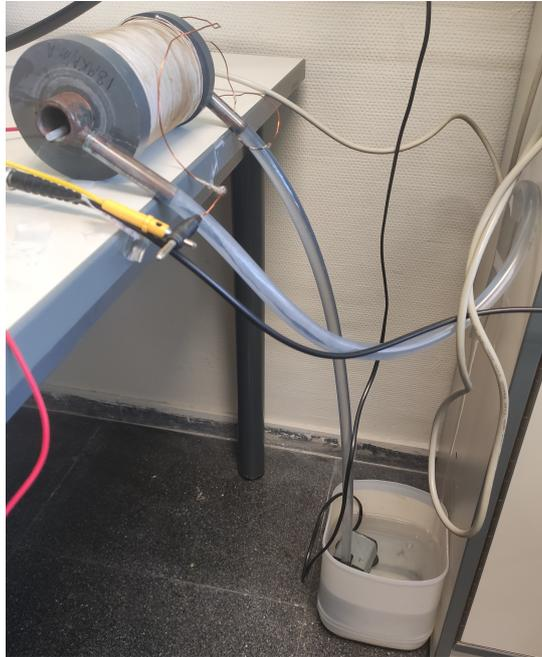
**Figura 5.3:** Bobina de 18.9 KA/m·A de sensibilidad con bomba de refrigeración por agua, utilizada para crear el campo magnético de excitación mientras se estudia un FBG con el interrogador óptico.
