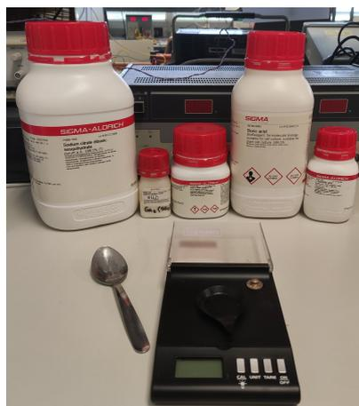
**Figura 3.10:** Compuestos químicos utilizados junto con báscula usada con el fin de medir las cantidades necesarias, para llevar a cabo la disolución empleada en la electrodeposición de Galfenol.
