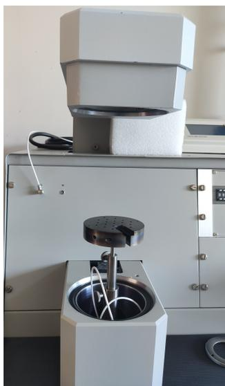
**Figura 3.3: Módulo de vacío en el que se introducen las muestras para hacer sputtering con el sistema LEICA EM MED020.**
