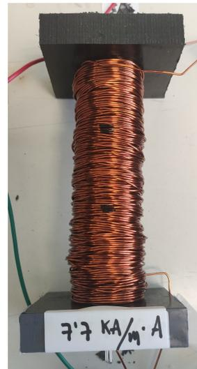
**Figura 3.18: Proceso de caracterización de la bobina excitadora. a) Gaussímetro utilizado para medir la inducción de la bobina excitadora b) Bobina excitadora caracterizada.**
