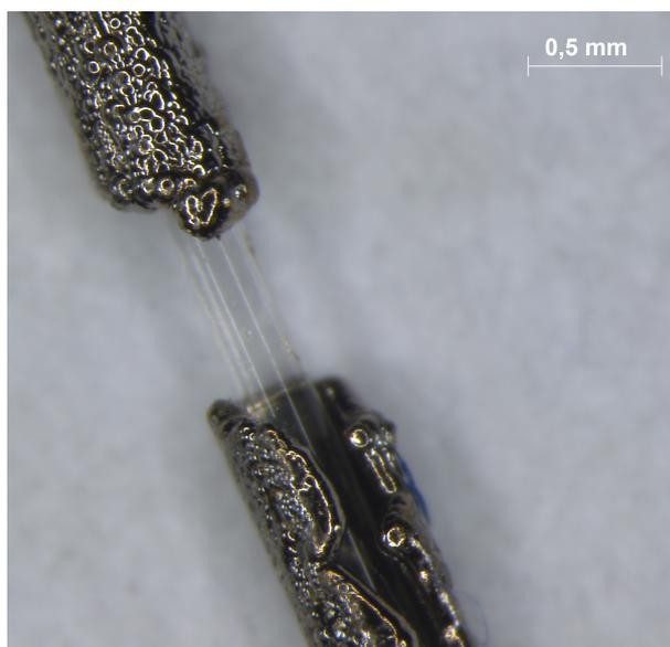
**Figura 4.29:** Detalle en el Microscopio Óptico de la deposición de la muestra F4, donde gracias a una rotura en la deposición, puede distinguirse también la fibra óptica.
