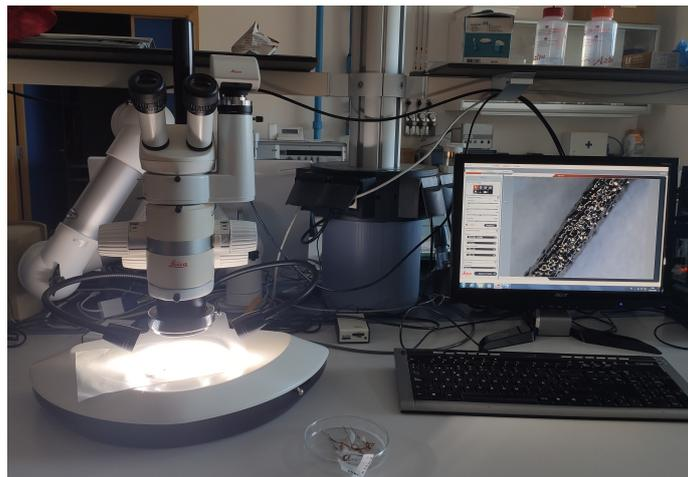
Figura A.3: Microscopio Óptico Lupa en Microscopía, UPV.
