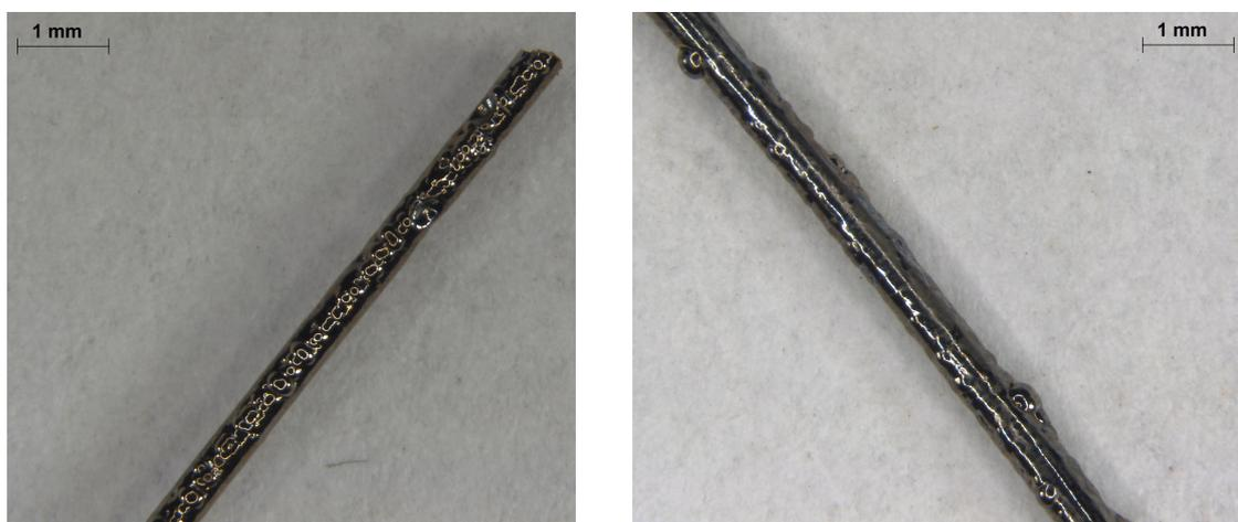
**Figura 4.10: Comparación de la uniformidad de la superficie depositada a diferentes pHs con imágenes obtenidas con el Microscopio Óptico, de las muestras a) FPH45A b)FPH5A.**
