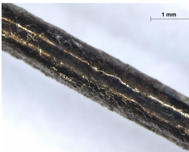
**Figura 4.15:** Foto detallada de la muestra TCUG1, observación de la uniformidad en la capa depositada.
