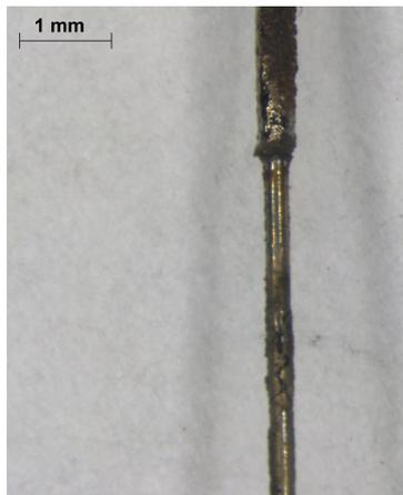
Figura 4.23: Detalle en el Microscopio Óptico de la parte de una fibra con FBG depositada con Galfenol.
