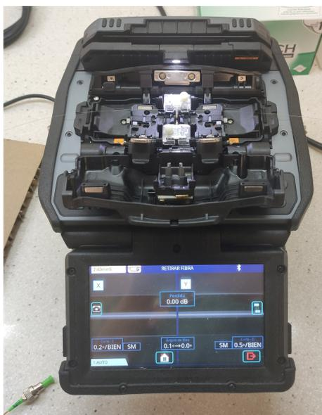
**Figura 5.2: Máquina que une la FBG a un conector con el objetivo de poder analizarla con el interrogador óptico.**
