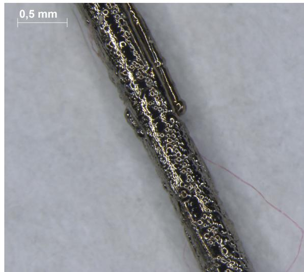
**Figura 4.26: Detalle en el Microscopio Óptico de la deposición de la muestra F1.**
