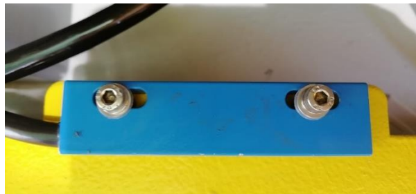
Figura 15. Sensor de intrusión instalado en una boya real.
