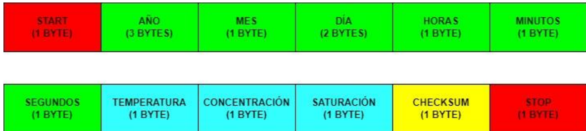
Figura 10. Trama del módem. Está partida para su mejor legibilidad, se transmite como una trama entera.
