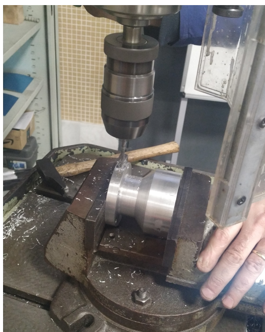
Figura 5.16: Torreta en el taladro.
