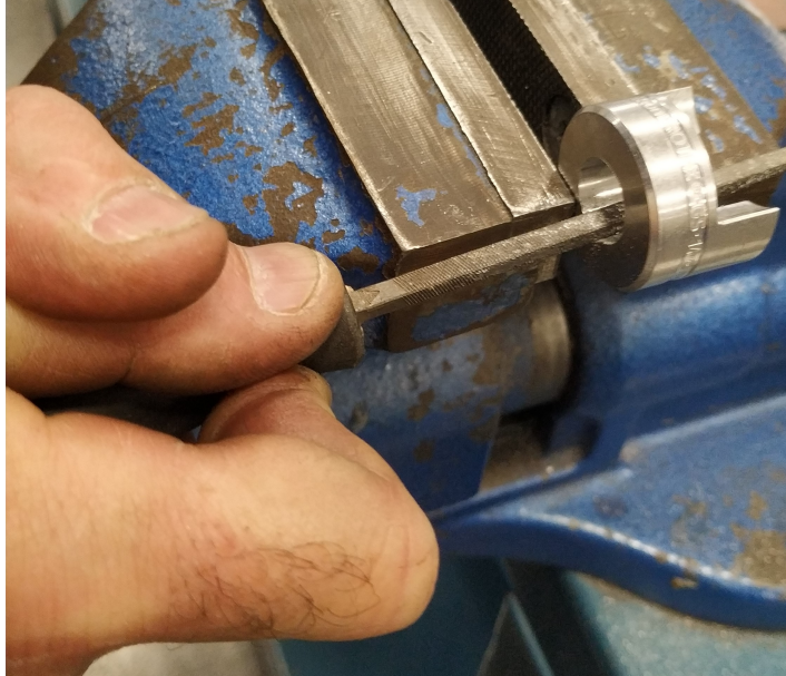
Figura 5.19: Limado manual del chavetero.
