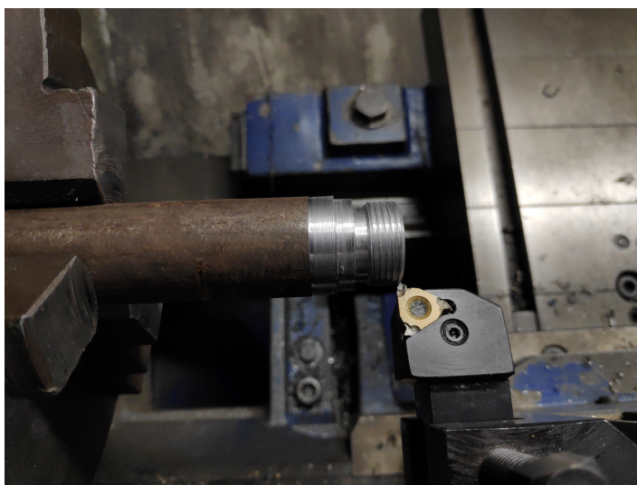
Figura 5.17: Portabolas en el paso de roscado.
