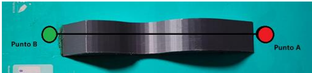
Figura 83 Imagen sin diferencia en el eje y del punto A al punto B.
