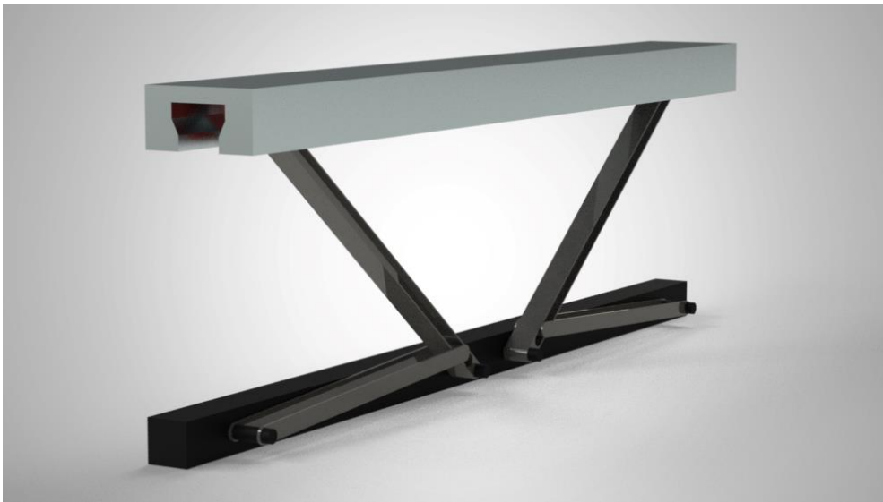
Ilustración 27: Doble pantógrafo simple con ranura-pasante (Propio)
