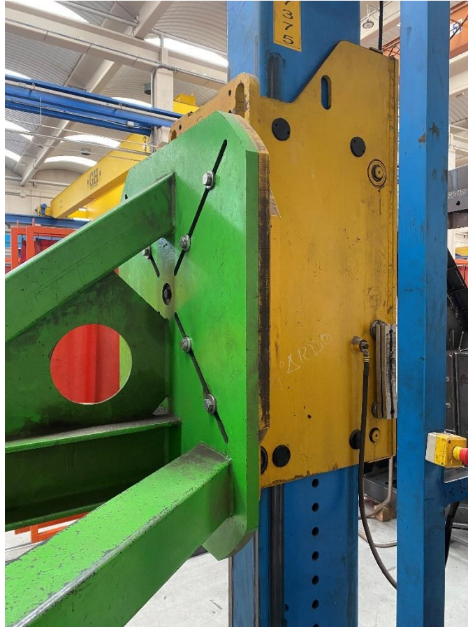
Figura 37. Placa del U17053400S001100 anclada a la placa del virador.
