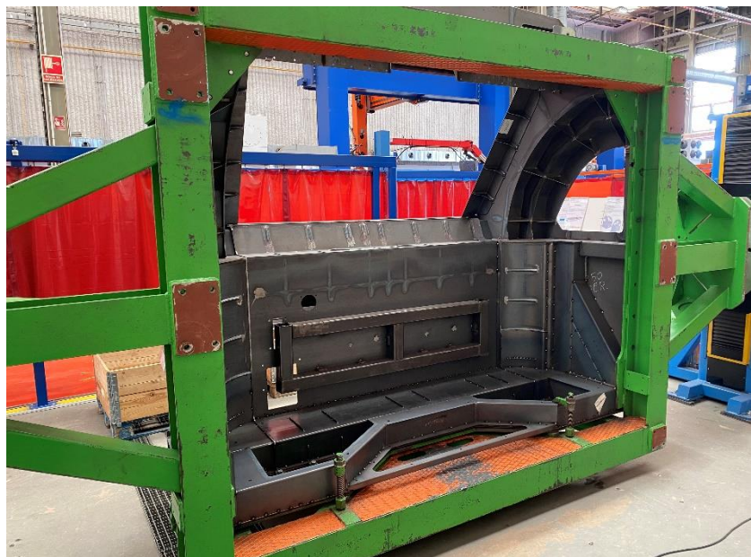
Figura 53. Placas de amarre mecanizadas con imprimación.
