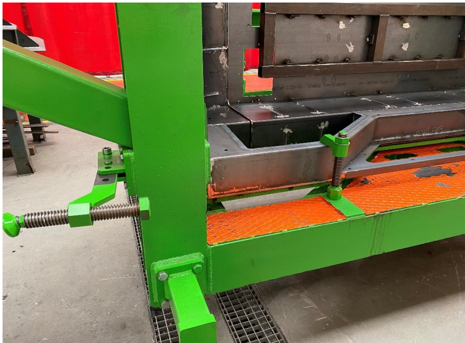
Figura 93. Conjunto husillo montado en la estructura.
