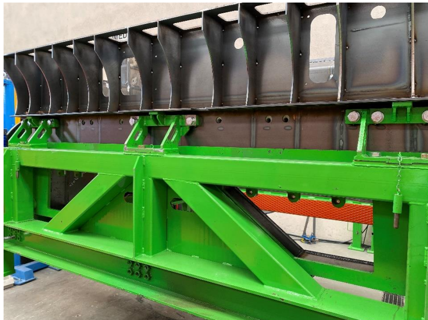
Figura 76. Amarres posicionados en la estructura principal.
