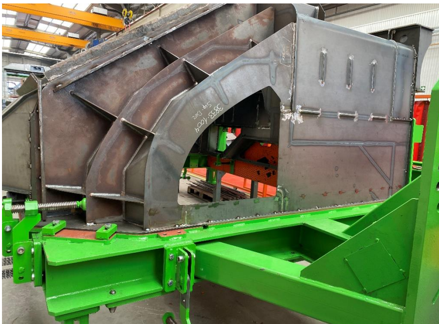
Figura 87. Conjunto apriete II en la estructura lateral derecha.
