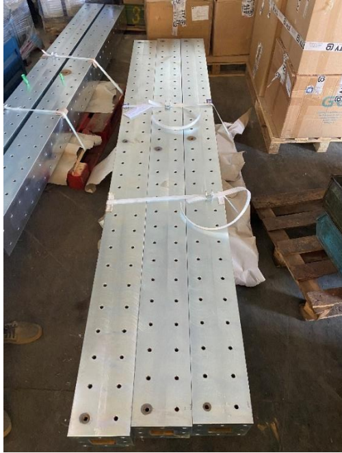
Figura 21. Viguetas recocidas de 3 metros.
