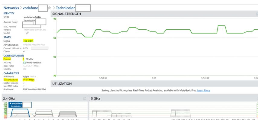
Figura 51 – Gráfica de la potencia de señal recibida (dBm) del punto de acceso real.
