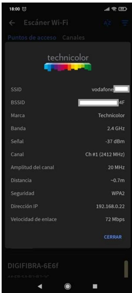
Figura 52 - Potencia de la señal recibida a 0.7m.
