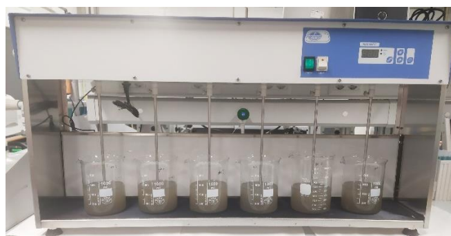
Figura 22. Equipo Jar-Test (FLOCUMATIC)
