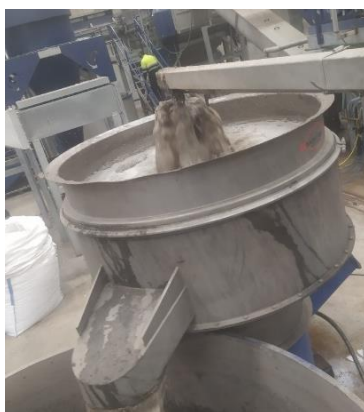
Figura 3. Tamiz vibratorio de 500 micras
