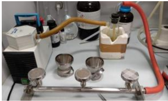
Figura 26. Rampa de filtración para SS
