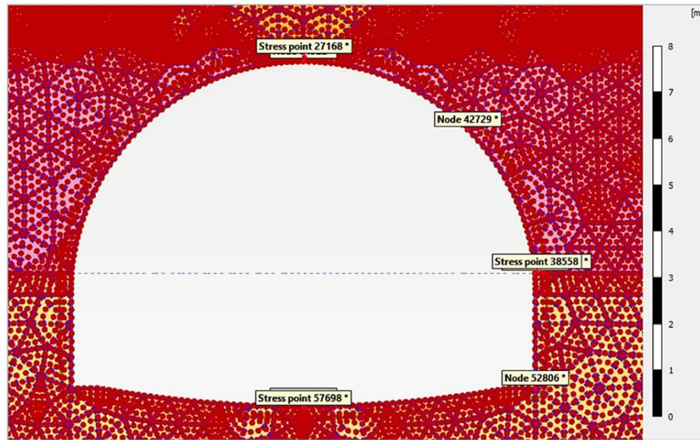
Figura 13. Puntos de control de desplazamientos y tensiones. (Fuente: Elaboración propia)
