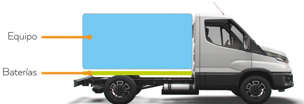
Figura 41. Distribución de las celdas en el equipo
