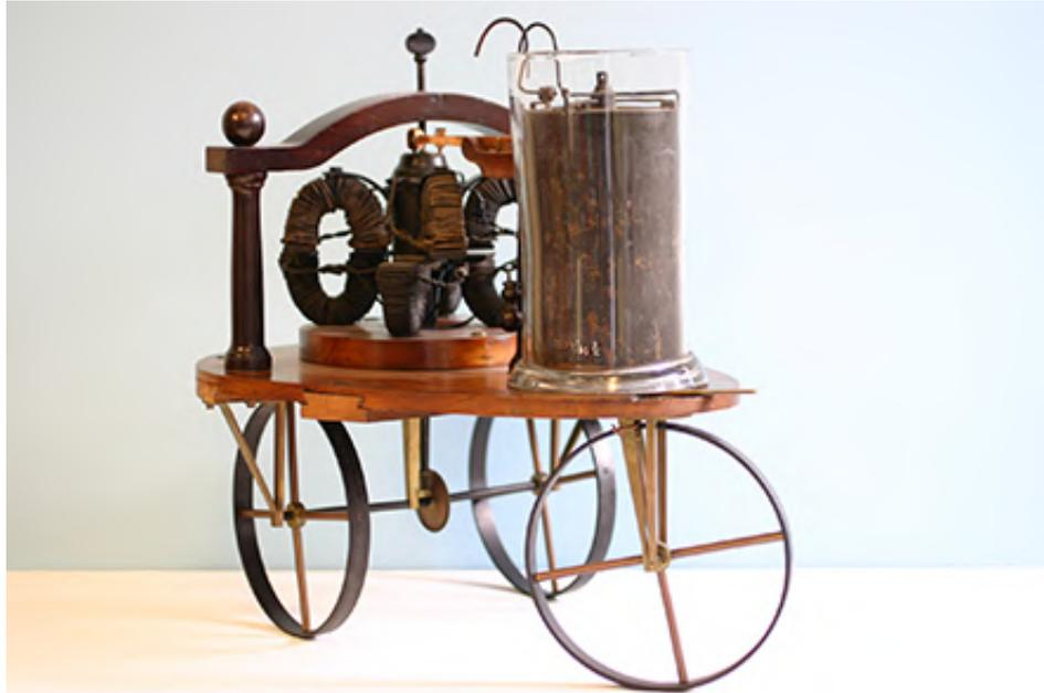
Figura 5. Primer vehículo eléctrico que incorpora batería.
