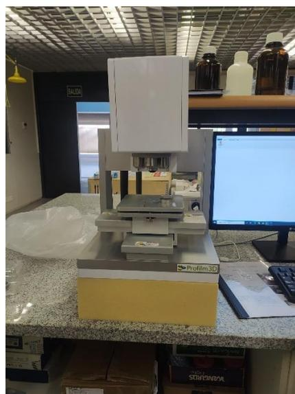
Figura 17. Perfilómetro Filmetrics Profilm 3D.
