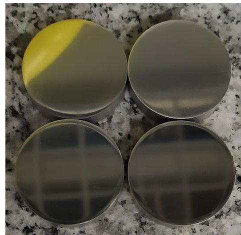
Figura 4. Muestras del material biocompatible CoCr utilizadas para los ensayos.
