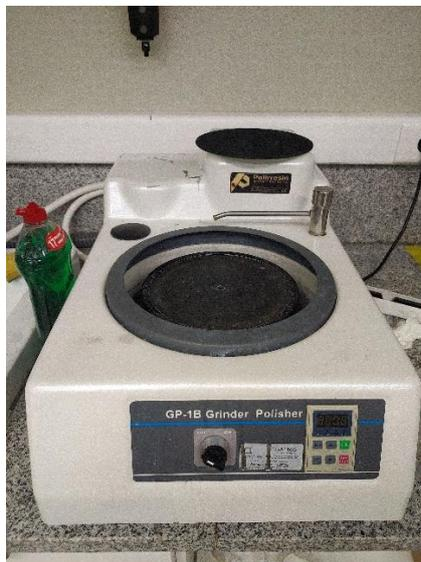
Figura 130. Pulidora utilizada para preparar las muestras.
