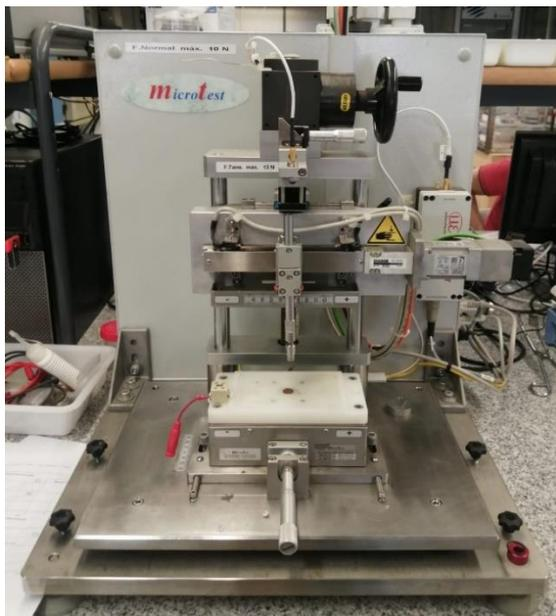
Figura 3. Tribómetro recíprocante MTL/10/AT de la marca *microtest*.
