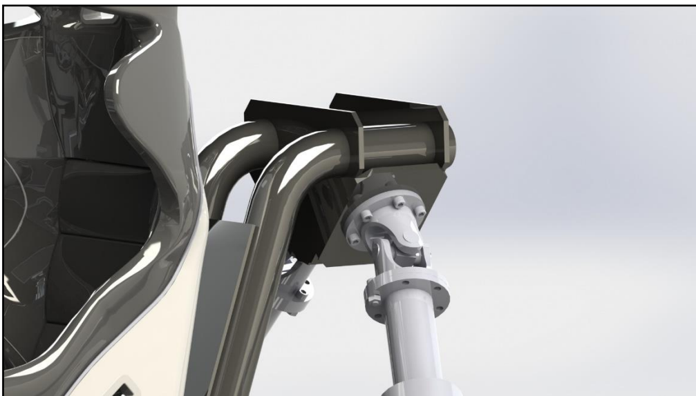
Ilustraci3n 7. Sistema de articulaci3n del simulador
