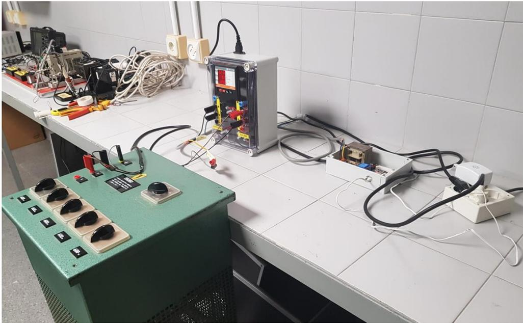
Figura 5.13: Montaje laboratorio. Caracterización sensores de medida
