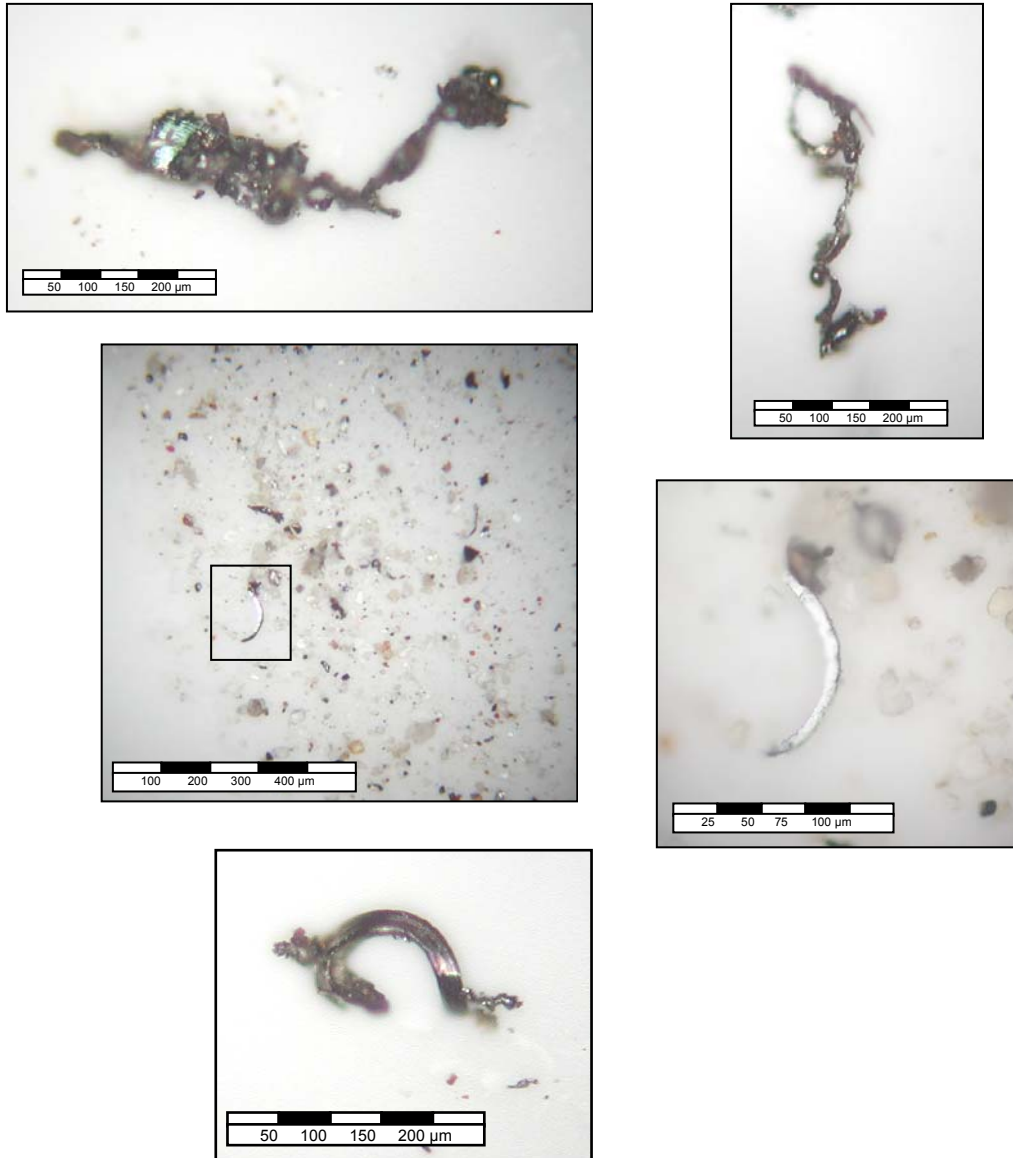
Figura D.10. Partículas ferrosas de corte.
