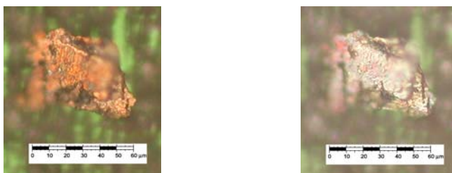
Figura 4.3 Efectos del tratamiento térmico sobre un fragmento de cobre..
