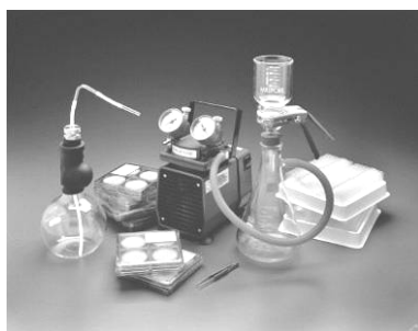
Figura 3.30. Instrumental empleado en el filtrado con membranas.
