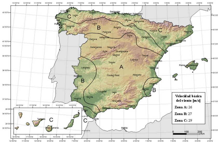
Ilustración 27: Zonas eólicas. Fuente CTE-DB-HS1
