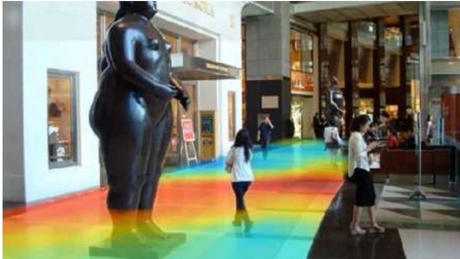
Figura nº13: Representación en color anomalías del campo magnético terrestre provocada por la estructura metálica del edificio
