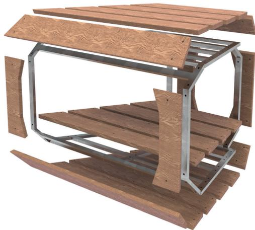
Una vez las estructuras se finalicen y lleguen al lugar de montaje y las tablas se hayan cortado a medida y lijado, se procede a recubrir las estructuras con las tablas. Las uniones entre madera y estructura se realizan con tornillos y tuercas de M6 que, posteriormente serán recubiertos por tapapernos y tapatuercas. La forma de atornillar es de exterior a interior.
