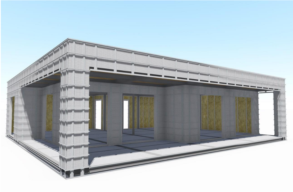
Figura 12. Vivienda prefabricada sin acabados finales. Fuente: Hauss Modular.
