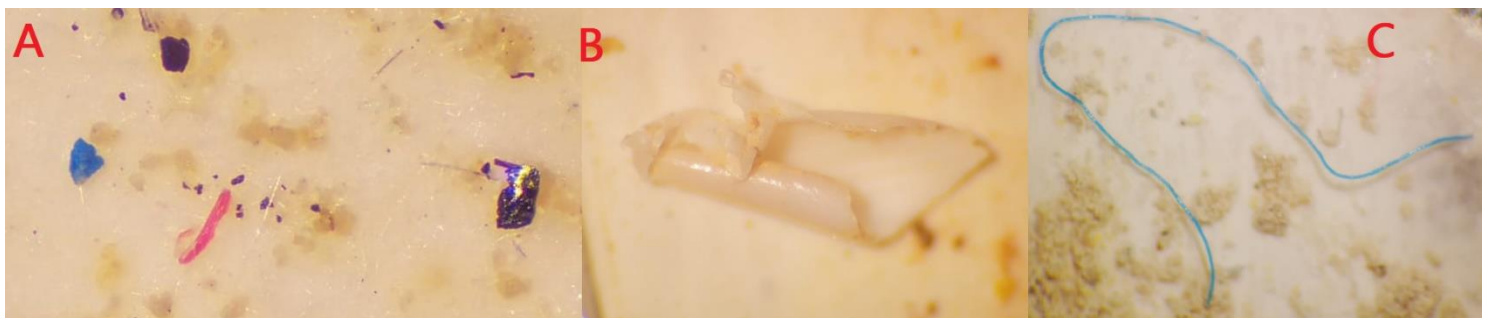
Figura 33. Ejemplos de MPs encontrados en las muestras. A) partículas; B) film; C) fibra.
