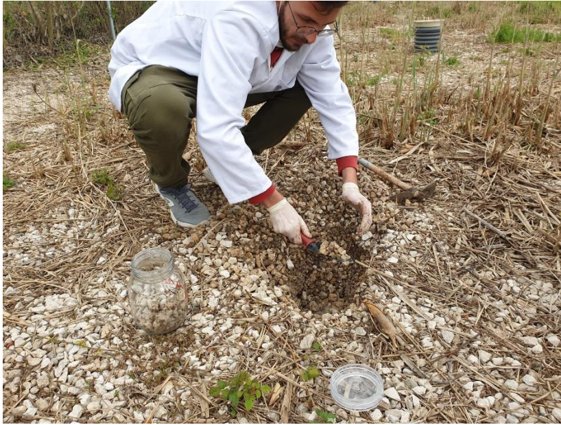
Figura 13. Campaña de muestreo de gravas en los HA de Carrícola, en este caso a la salida.
