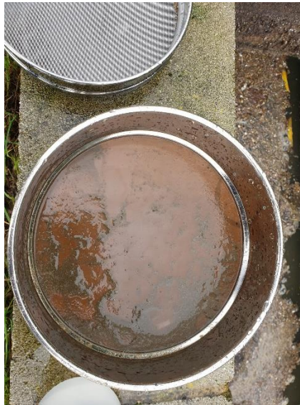
Figura 10. Ejemplo de tamiz recién tomada la muestra y antes de pasarla al vaso, en este caso el tamiz intermedio de 75 \mu\text{m} .
