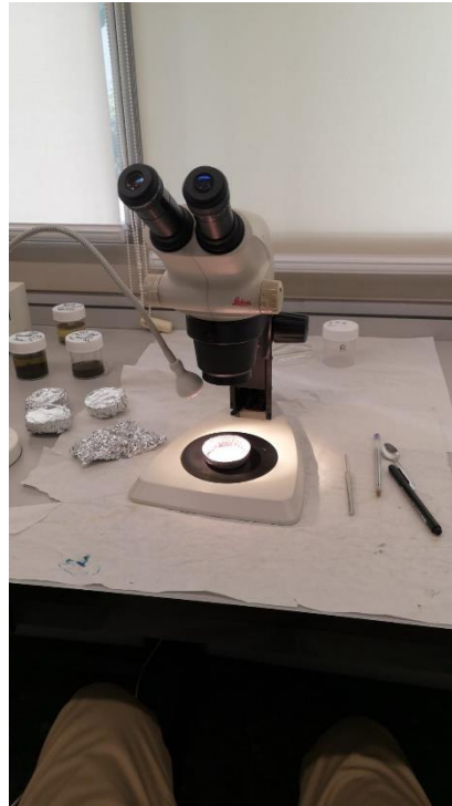
Figura 26. Equipo de observación mediante estereomicroscopio usado en laboratorio para examinar filtros visualmente o con ayuda de la aguja caliente.
