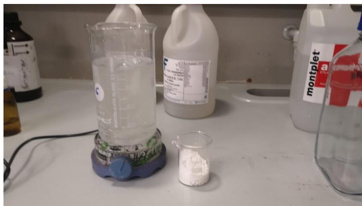
Figura 17. Proceso de disolución del cloruro de calcio, reacción exotérmica.
