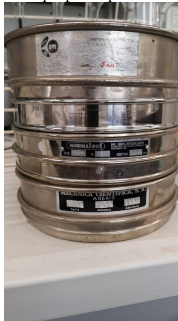
Figura 9. Columna de tamices para separación de las muestras en distintos tamaños.
