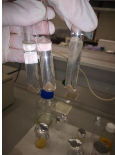
Figura 16. Sedimento tras la separación por densidad en el fondo del vial.
