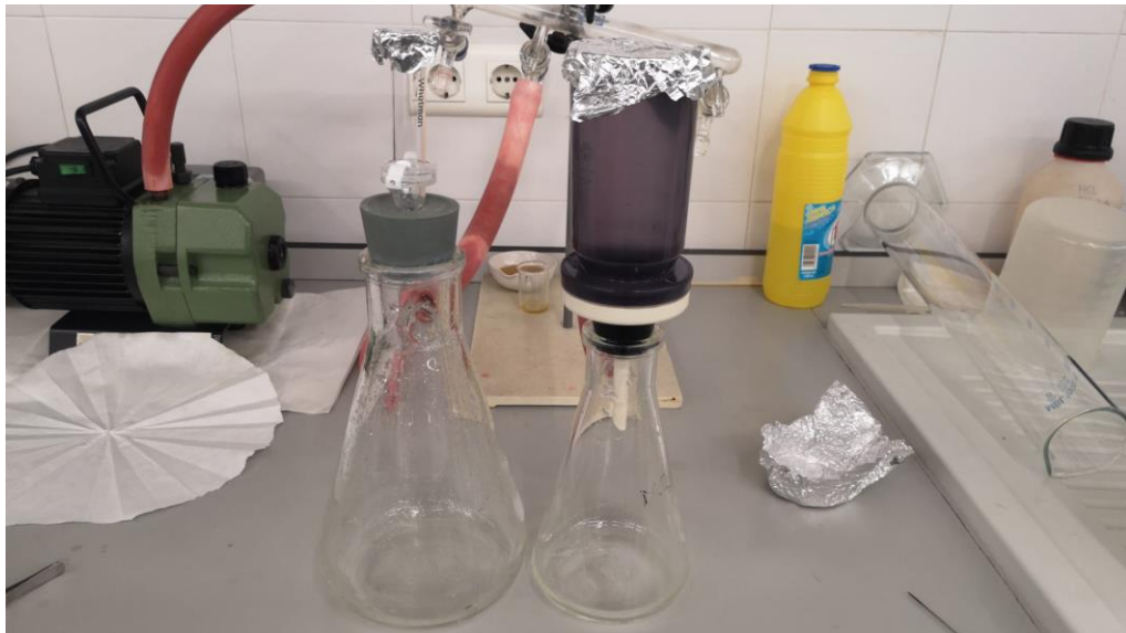
Figura 24. Nuevo equipo de filtración para FTIR (izquierda) junto al anteriormente usado.
