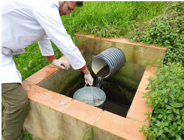
Figura 8. Día de muestreo, en el punto 5 de Carrícola, tomando muestra con el cubo metálico con todas las medidas para evitar la contaminación de la muestra.
