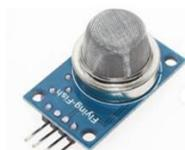
Figura 12. Sensor de gases MQ-8
