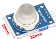
Figura 10. Sensor de gas MQ-6
