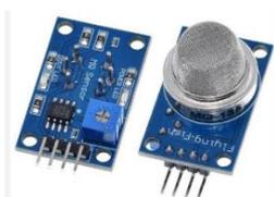
Figura 13. Sensor de gas MQ 135
