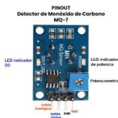
Figura 11. Sensor de gases MQ-7
