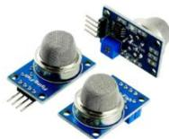
Figura 6. Sensor de gas MQ-2
