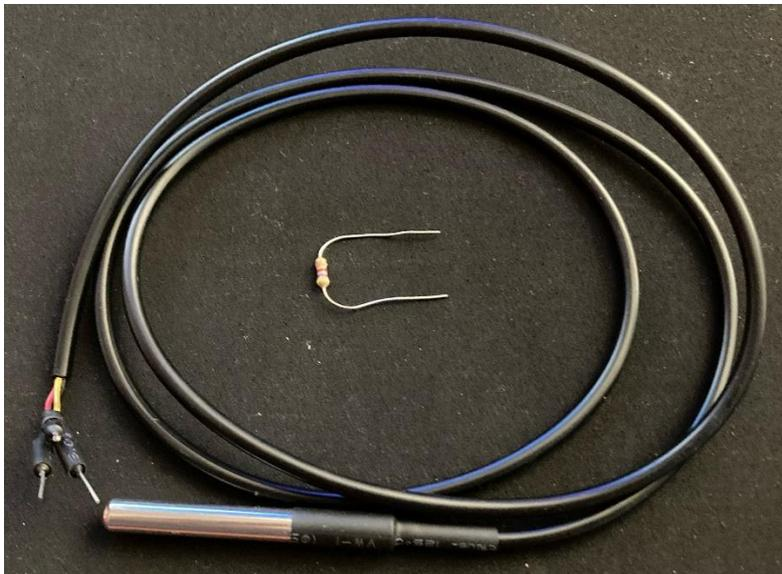
*Figura 3. Sensor de temperatura DS18B20*
