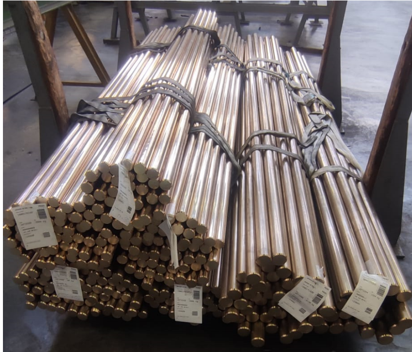
Figura 17: Barras de \varnothing 38 recién fabricadas.
