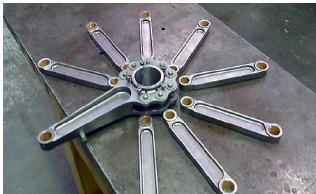
Figura 2-5. Posición biela principal y bielas secundarias. (Fuente: " www.actualidadmotor.com ")
