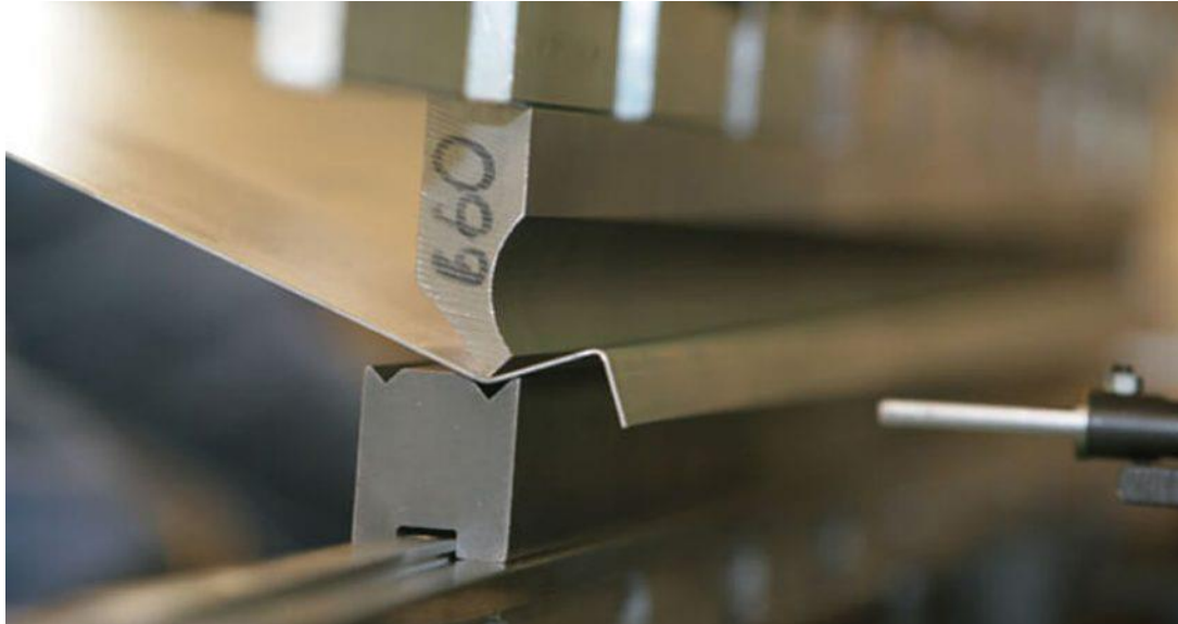
figura 40 detalle doblado chapa
