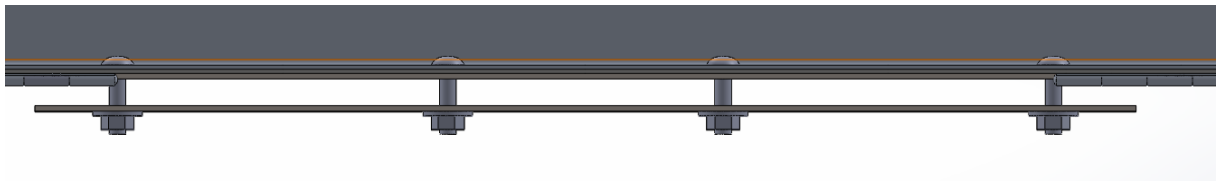
figura 39 detalle colocación tornillos tuerca y arandela
