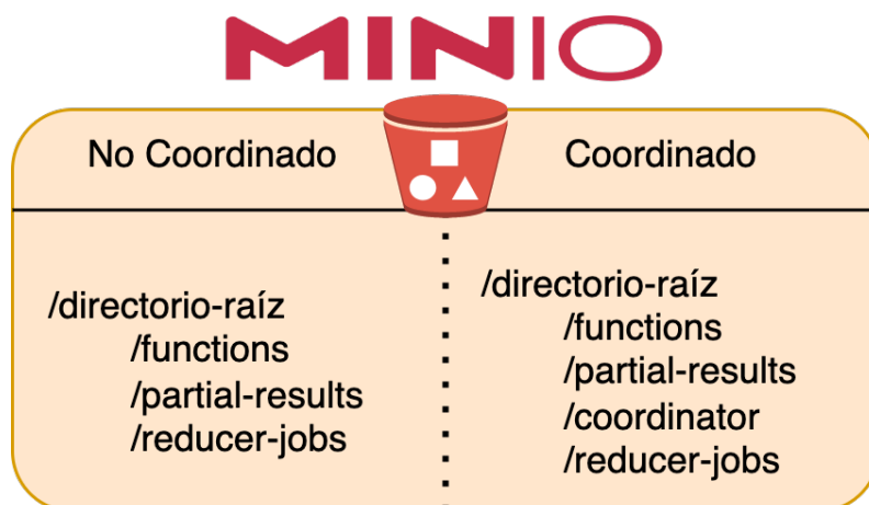
Figura 3.5: Estructura del sistema de almacenamiento interno dependiendo del modelo de reducción.
