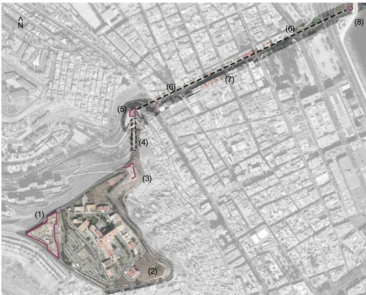
Fig. 15 Esquema defensivo norte original. Elaboración propia sobre ortofoto de GRAFCAN
