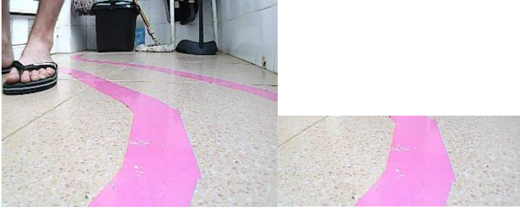
Figura 31. Fotograma de la cámara del coche ante un giro brusco con su correspondiente recorte de la mitad superior Fuente: elaboración propia
