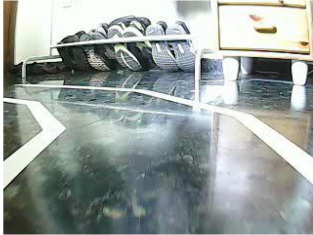
Figura 23. Fotograma de la cámara del coche ante un circuito con suelo reflectante Fuente: elaboración propia
