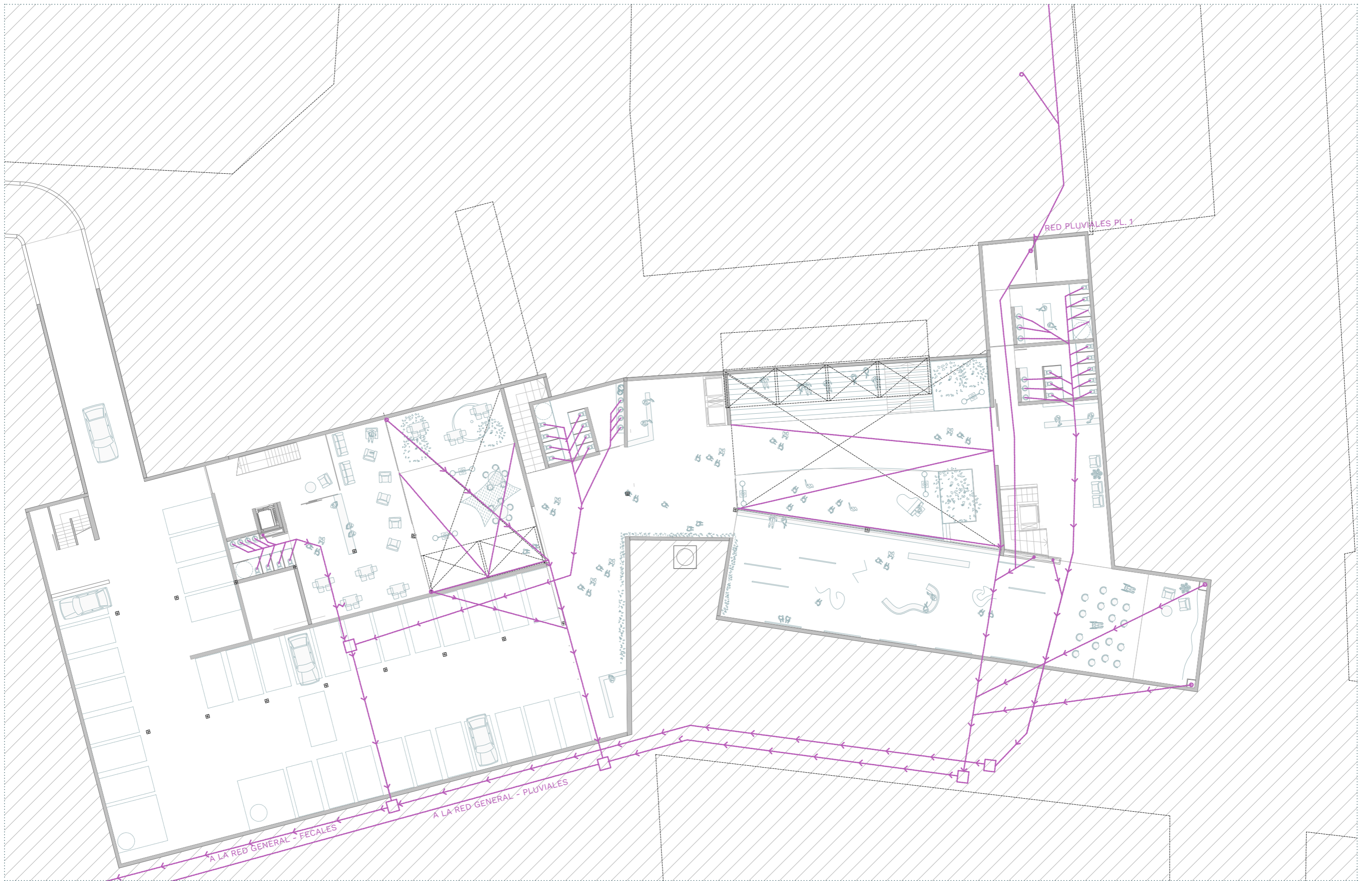
PI-04 | INSTALACIÓN SANEAMIENTO | CONEXIÓN RED PLUVIALES Y FECALES A RED GENERAL | PLANTA -1 | COTA -3,50m | E: 1/300
