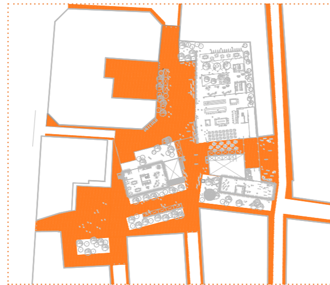
Pavimento piedra, en zonas exteriores generales: plazas y accesos a edificio
