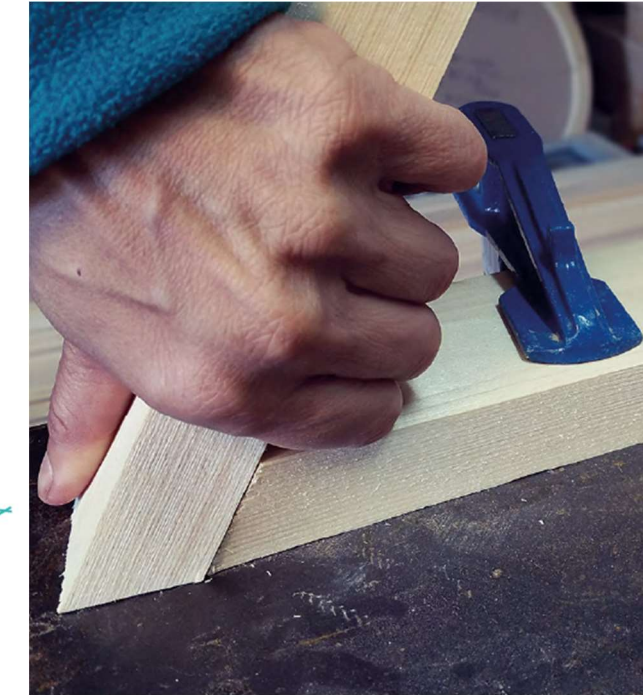
Ilustración 4. Disposición de los triángulos lado derecho testa/cara interior.
