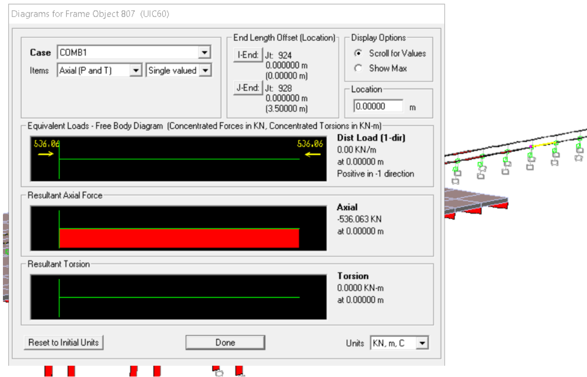
Figura 15. Axil compresión lado derecho. (Fuente: Elaboración propia en software SAP2000).
