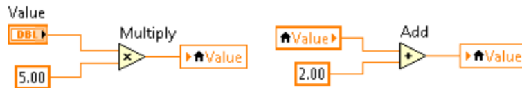
Fig. 19. Ejemplo de código en el que se producen dos hilos de ejecución [20].
