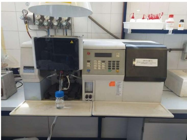
Figura 10. Equipo de espectroscopía de absorción atómica.
