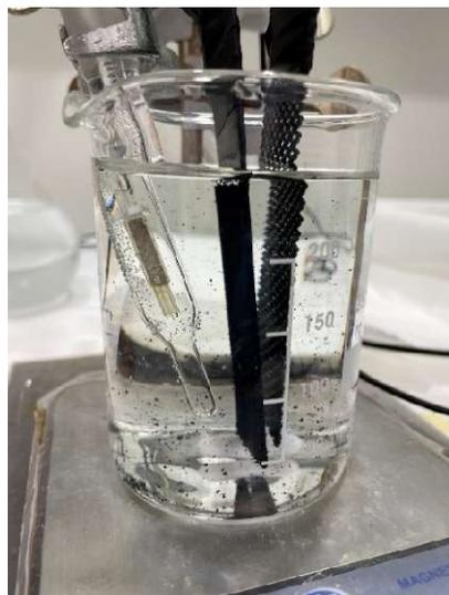
Figura 16. Imagen del desprendimiento del antimonio causado por la aparición de burbujas de hidrógeno en el electrodo en un reactor de compartimento único.
