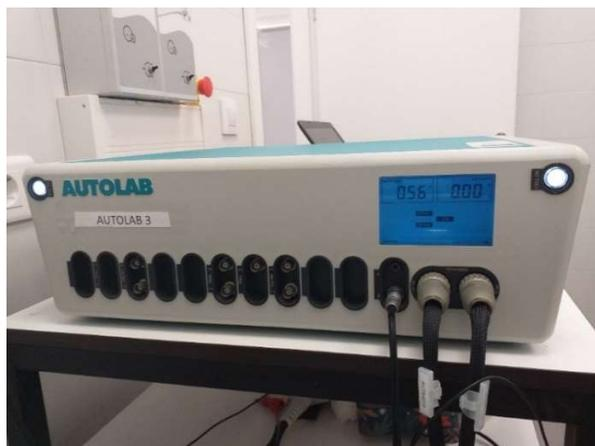
Figura 9. Equipo utilizado para las voltametrías: potenciostato-galvanostato.
