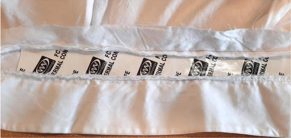
*FIGURA 58.. Adhesivo conductor térmico de doble cara. Fuente propia.*
