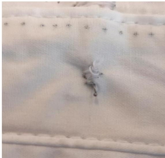
FIGURA 61. *Punta del termopar en contacto con el cuello. Fuente propia.*
