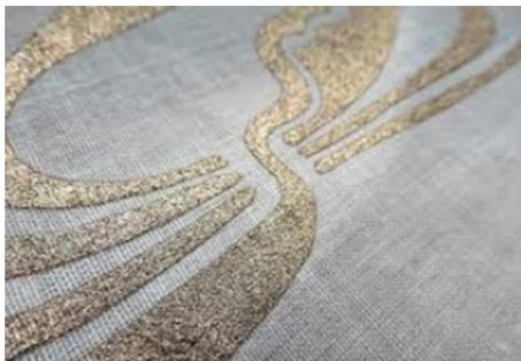
*FIGURA 15. Ejemplo de impresión. Tinta conductora de plata impresa sobre textil.*
