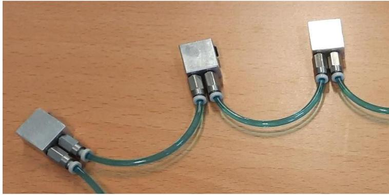
FIGURA 50. Disipadores por líquido para las Peltier. Fuente propia.
