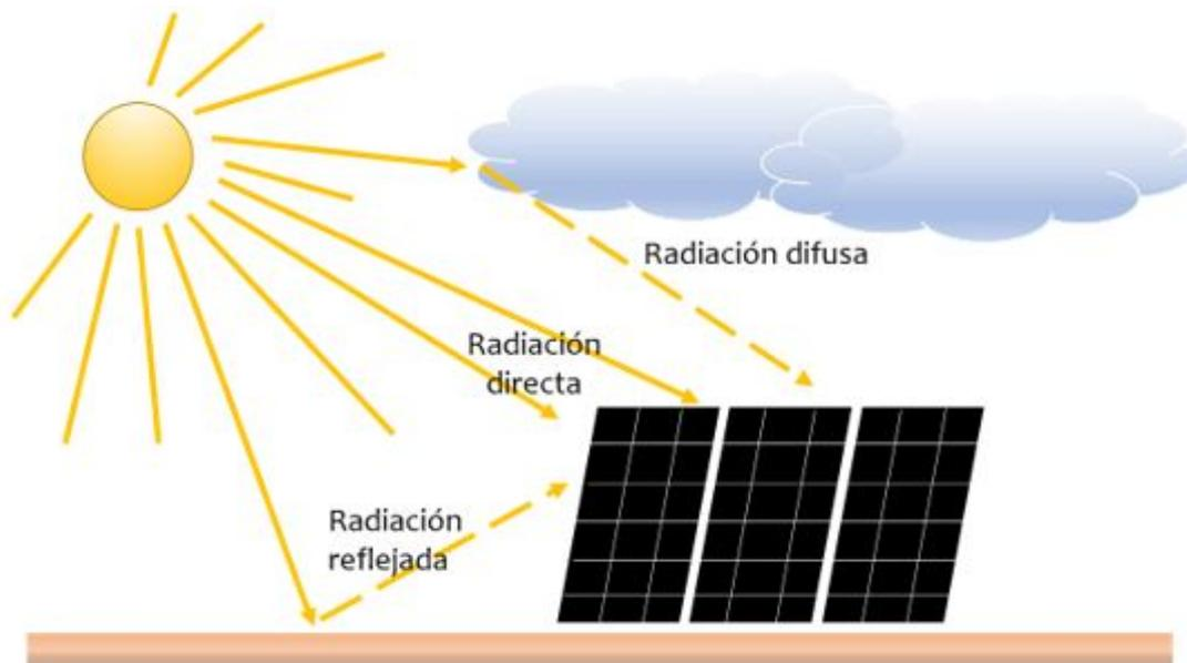
Figura 1.1: Tipos de radiación solar
