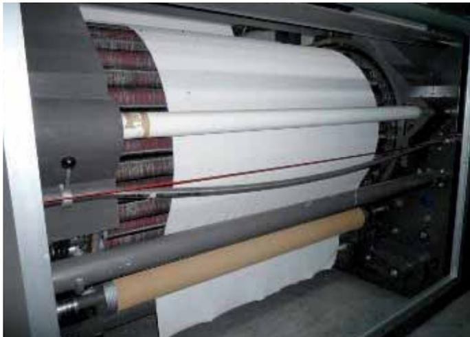
**Figura 2.18:** Máquina utilizada para el perchado de género de punto tubular
