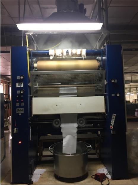
**Figura 2.19:** Vista delantera de una compactadora de género de punto tubular modelo Heliot HC 95 PI
