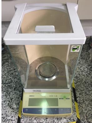
**Figura 2.30:** Balanza de precisión utilizada en el análisis del tejido en esta investigación
