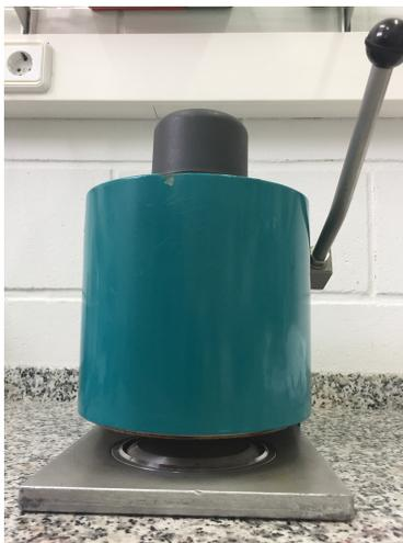
**Figura 2.29:** Cortaprobetas utilizado para el análisis del tejido en esta investigación
