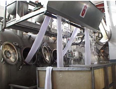
**Figura 2.12:** Vista de una máquina de tintura por cuerda MultiflowI
