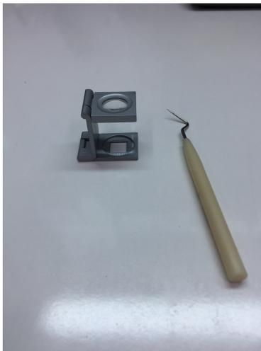
**Figura 2.28:** Cuentahilos utilizado para el análisis de la densidad de malla
