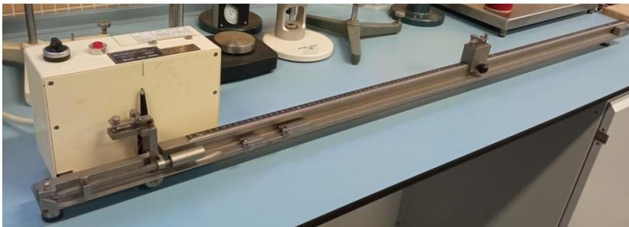
**Figura 2.31:** Aparato utilizado para la medición de la longitud de un hilo
