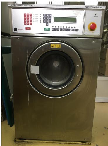
**Figura 2.27:** Lavadora normalizada modelo Electrolux Wascator FOM71MP utilizada para el análisis de los tejidos utilizados en esta investigación
