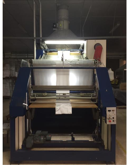
**Figura 2.20:** Vista trasera de una compactadora de género de punto tubular modelo Heliot HC 95 PI
