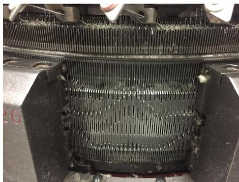
**Figura 2.10:** Formación de malla de la máquina circular de interlock modelo Mayer IHG II
