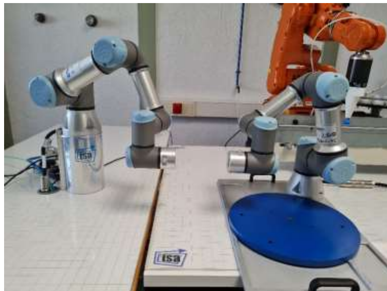
Fig23. Espació de trabajo con dos UR3e
